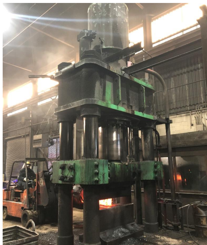
2000 Ton Hydraulic Open Die Press
